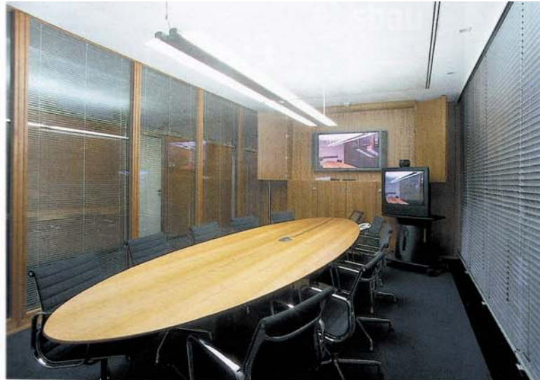
Unmittelbar neben dem zentralen Atrium liegen die Besprechungsräume. Die schlanken Leuchten sind mit einer neu entwickelten Mikropyramiden-Strukturoptik entblendet.
