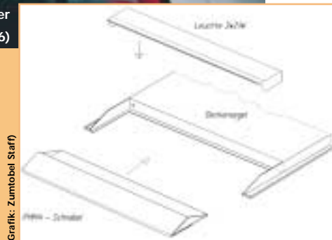
Intelligent gelöst ist die Anbindung der Hohlkörperleuchte an das Deckensegel (7)
